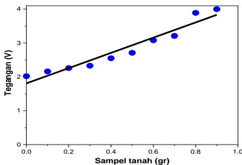
**Gambar 5.** Grafik karakteristik sensor dengan air tanah
