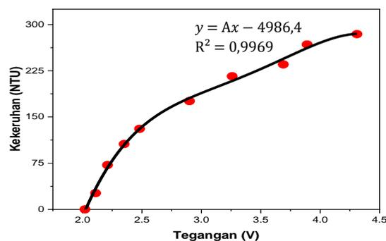
**Gambar 8.** Grafik kalibrasi tegangan dengan kekeruhan (air abu)
