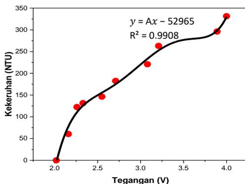
**Gambar 6.** Grafik kalibrasi tegangan dengan kekeruhan (air tanah)
