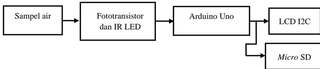
**Gambar 2.** Diagram blok
