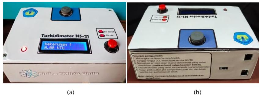
**Gambar 4.** Realisasi rancangan alat bagian luar, (a) tampak depan, (b) tampak belakang
