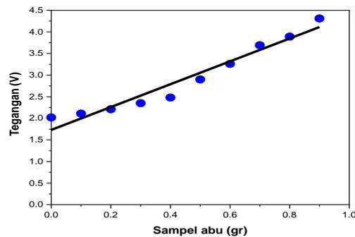
**Gambar 7.** Grafik karakteristik sensor dengan air abu
